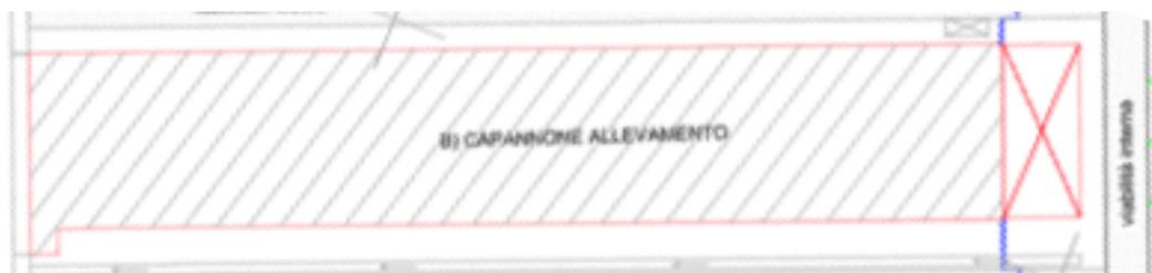
Pianta di uno dei capannoni dell'allevamento con il box di contenimento polvere.
