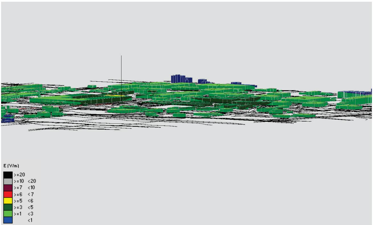
Fig. 10 Impatto Elettromagnetico – zona Via Comelli – Vista laterale senza solido
