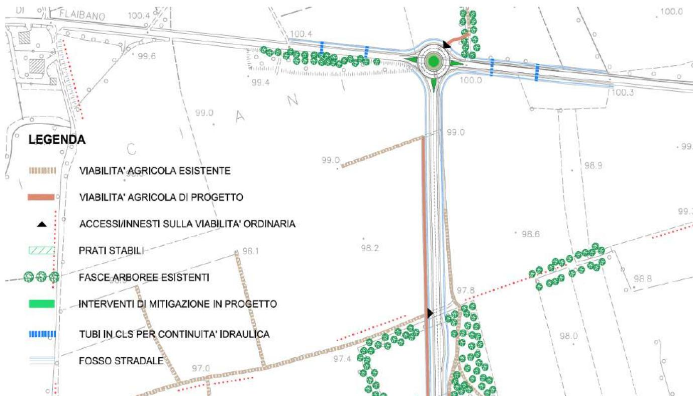
Interventi di mitigazione nei pressi dell'intersezione tra la S.P.60 e il nuovo collegamento viario. Da notare l'esecuzione dei tubi in cls per la continuità idraulica.
