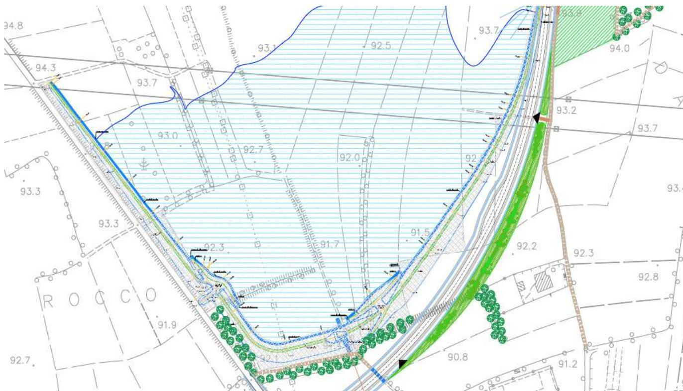
Interventi di mitigazione nei pressi dell'intersezione tra la S.P.52 e il nuovo collegamento viario. Da notare la realizzazione della barriera verde a protezione del abitato di Blessano e del Campo sportivo.
